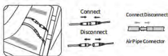
Подключение/отключение/коннектор воздушной трубки
